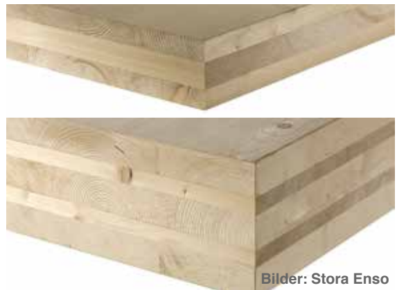
Abb. 15 Die Deckschichten der Elemente übernehmen die statische Hauptfunktion. Die mittleren Lagen sind statisch gesehen „Abstandshalter“ und bilden die Sperrlage (oben dreischichtiger und unten fünfschichtiger Aufbau).
