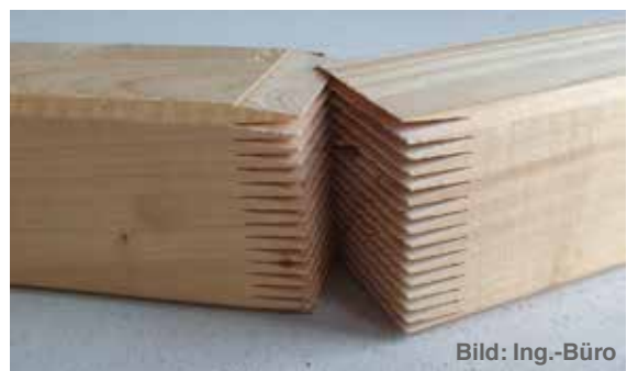
Abb. 11 Keilzinkenverbindung zum Fügen eines Endlosstranges
